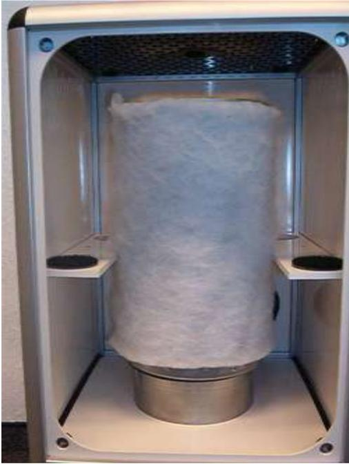
Überprüfen Sie anschließend den Sitz der Filterpatrone. Der zylindrische Ansatz der Filterpatrone soll auf der Bodenfläche der Filterkammer aufliegen.
