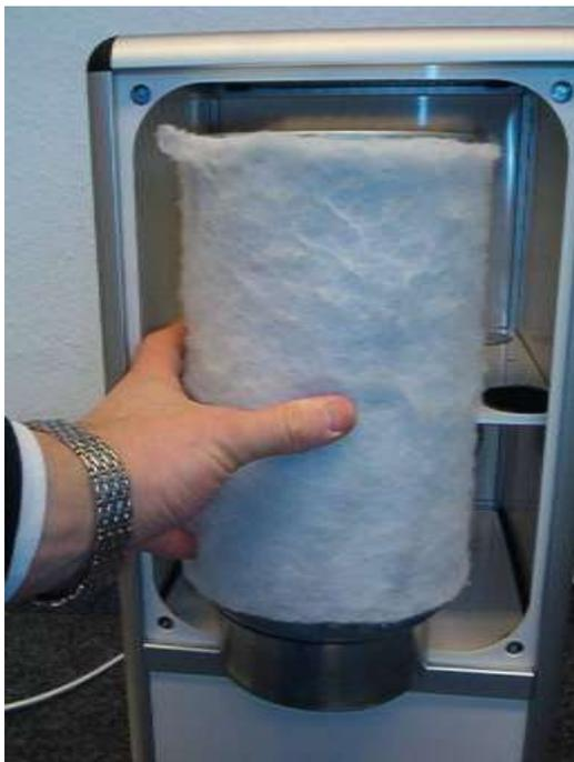
Setzen Sie die Filterpatrone auf den Ansaugstutzen des Ventilators. Führen Sie hierzu die Filterpatrone aufrecht stehend in die Filterkammer und senken Sie diese dann von oben auf den Ansaugstutzen
