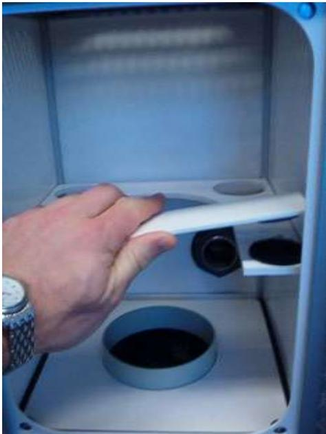
Öffnen Sie die Verriegelung der Filterpatrone und entnehmen das Verschlussstück
