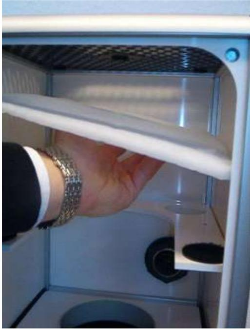
Prüfen Sie, ob die Filtermatte korrekt vor der oberen Ansaugöffnung sitzt. Ggf. entfernen Sie die Filtermatte und setzen sie wieder passend ein (Klettverschlüsse).
