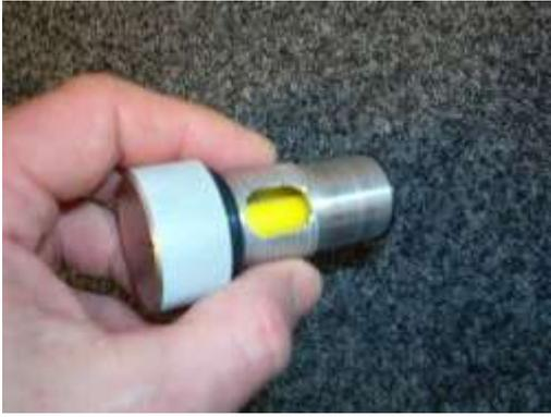
Entnehmen Sie eine Geruchspatrone und setzen Sie diese in die Aufnahme ein. Verschließen Sie die Aufnahme mit der schwarzen Verschlusskappe.
