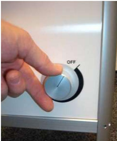
Durch Drehen des Reglers für die Ansaugleistung in Uhrzeigerrichtung stellen Sie nun das Gerät an. Der Ventilator läuft an.
