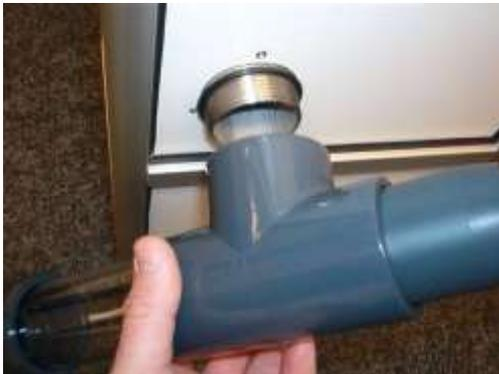
Schrauben Sie den Staubfang auf den Ansaugstutzen und richten ihn anschließend senkrecht so aus, dass der Stutzen für den Luftschlauch nach oben zeigt. Dabei sollte der O-Ring so fest am Gehäuse anliegen, dass der Staubfang verdrehsicher befestigt ist.
