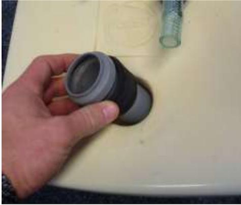
Stecken Sie den Wasserkasteneinsatz in die Öffnung des Wasserkastens. Die Eintauchhöhe können Sie durch Verschieben der Gummimanschette verstellen
